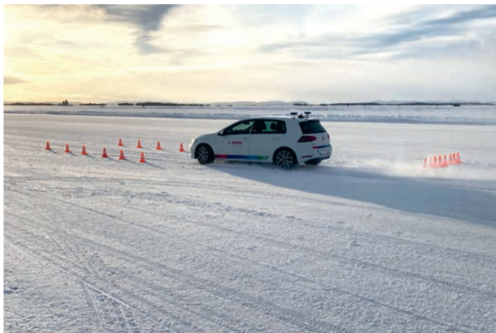
Die weiten Flächen in Nordskandinavien bieten sehr gute Voraussetzungen dafür, Bremssysteme wie das neueste Elektronische Stabilitätsprogramm ESP intensiv zu prüfen.
